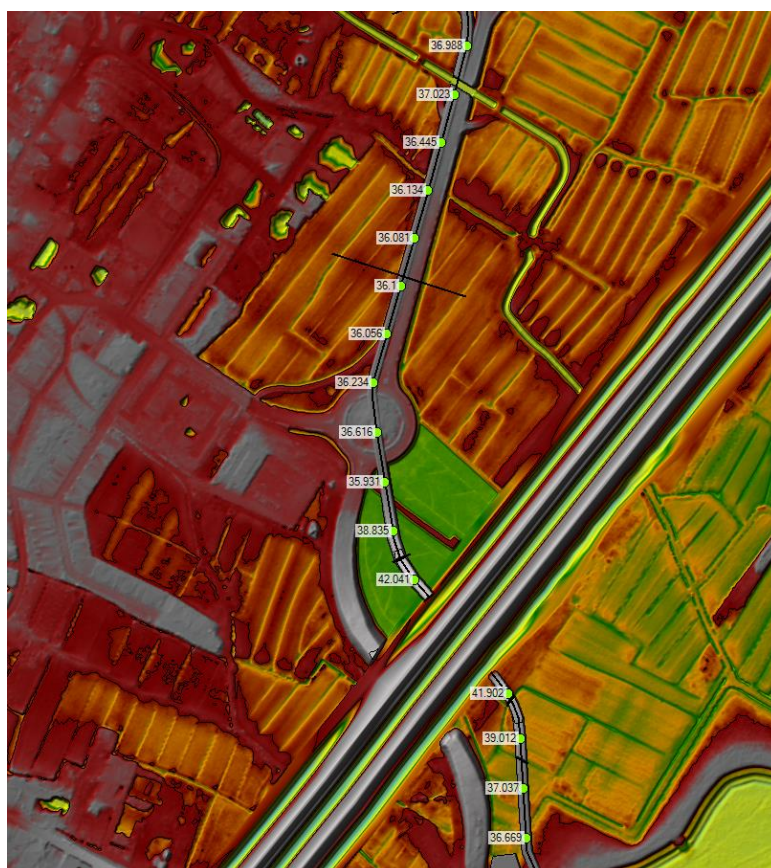
Figura 33. Sviluppo del rilevato tranvia impostato in RAS Mapper con i Ground Points
