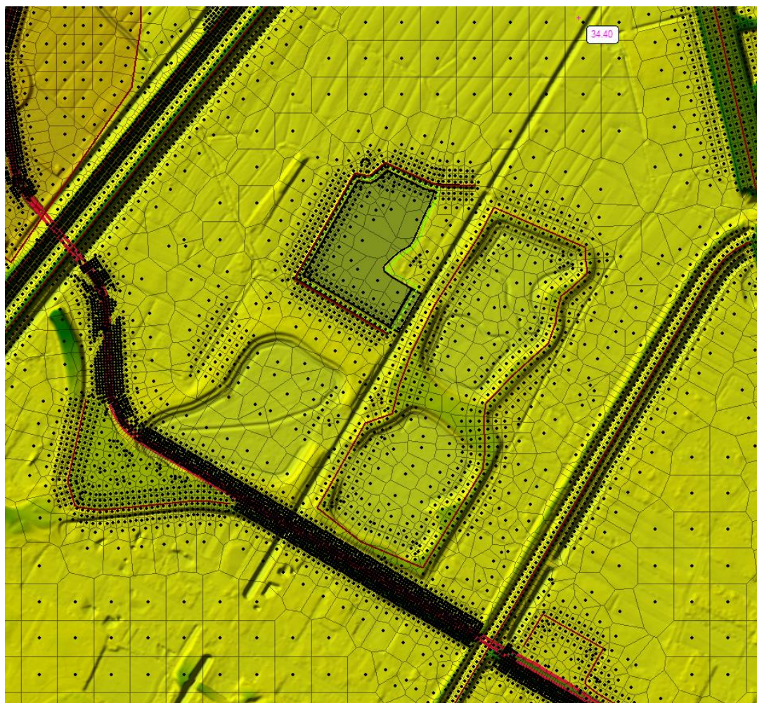
Figura 8. Particolare degli elementi Breakline in corrispondenza di argini e tracciato della tramvia
